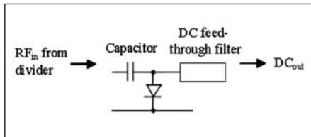
Figure 4 · Detector circuit.
